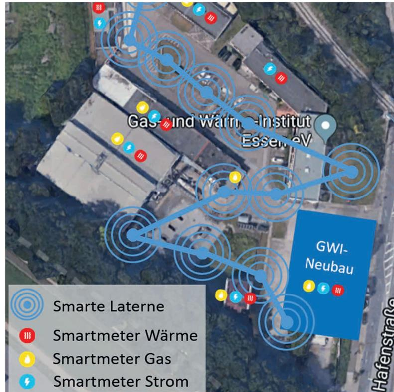
Im Living Lab, auf dem Gelände des GWI, ist eine Kommunikationsinfrastruktur etabliert, die aus 14 intelligenten Systemleuchten, den ED4, besteht.
